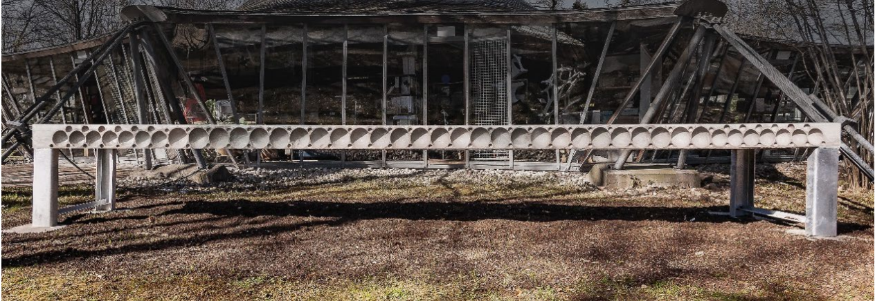
Abbildung 11: Mit mineralischen Hohlkörpern gradierte Betondecke © Daniel Schmeer / ILEK
